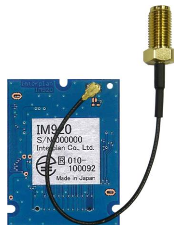
図4 接続ケーブル装着状態
