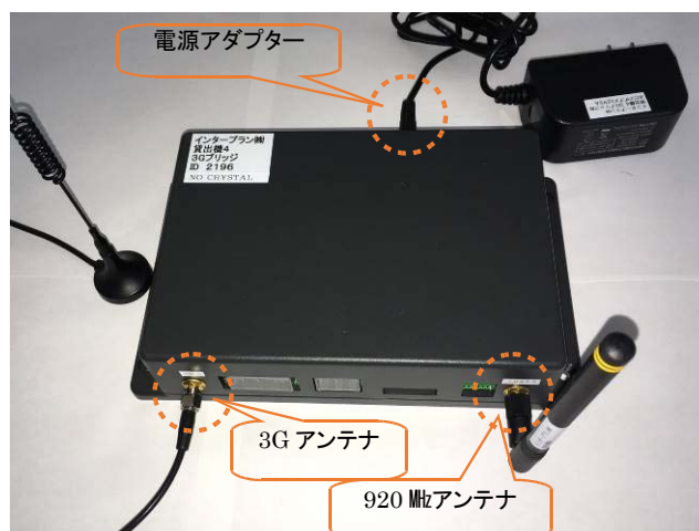
図3 3Gブリッジ組立て状態
