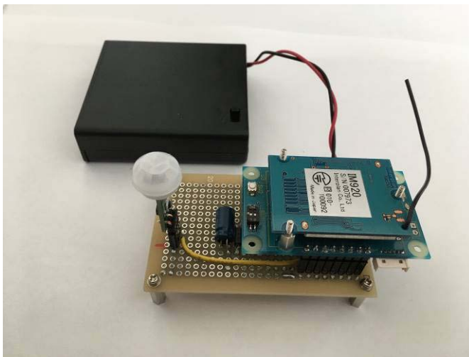
図8 人感センサーボードセット
