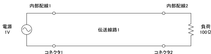
図1 有線通信の模式図
