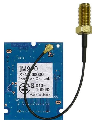
図4 接続ケーブル装着状態
