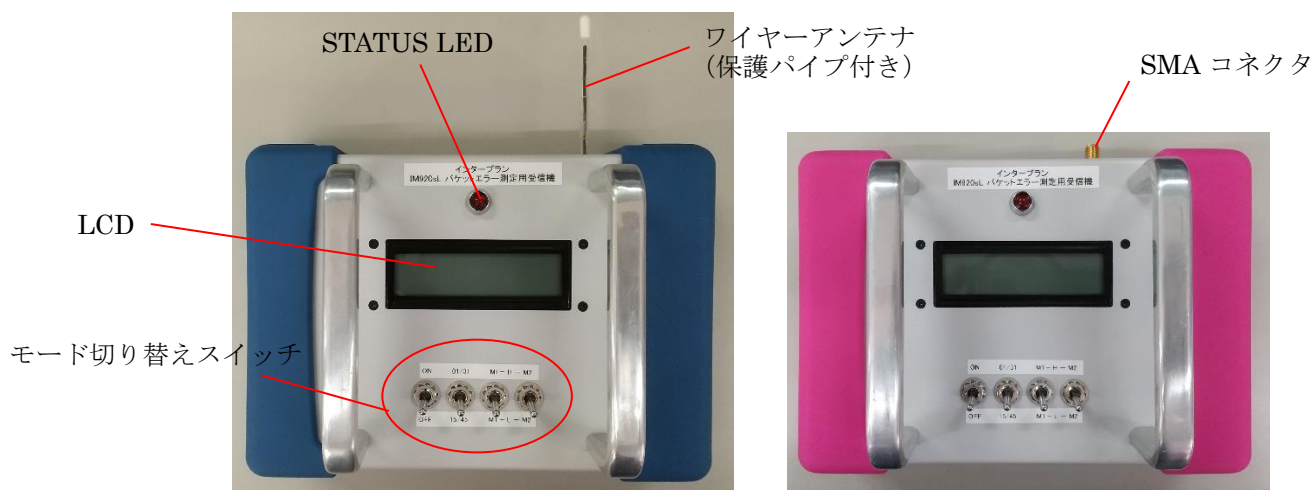
受信機 左側ワイヤーアンテナタイプ、右側外部アンテナタイプ
