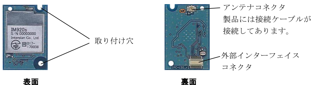
図 2 各部の名称 外部アンテナタイプ (IM920s-X シリーズ)
