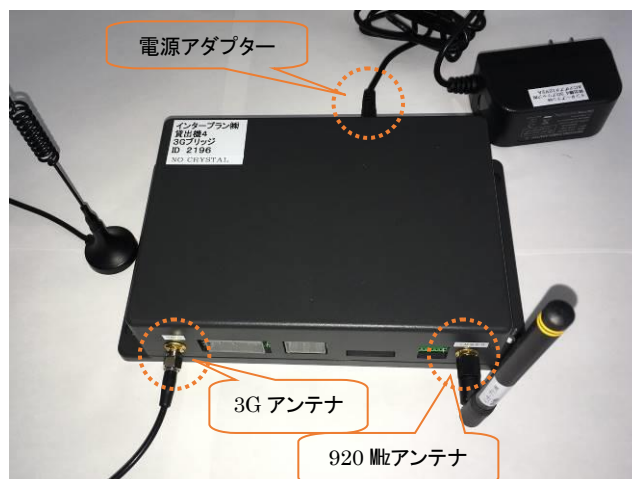
図3 3Gブリッジ組立て状態
