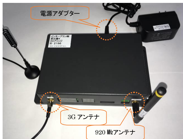
図3 3Gブリッジ組立て状態
